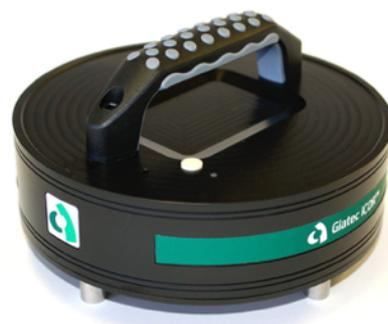
iCOR™ utilise la technologie sans fil pour transmettre les données à une tablette, où les données sont stockées, visualisées et analysées. L'application possède des outils de post-traitement puissants et permet d'échanger rapidement les résultats.
