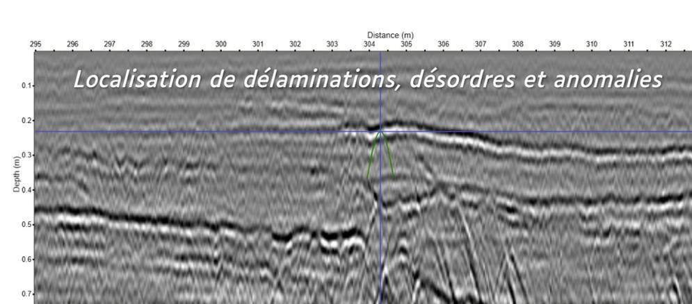
L'auscultation des chaussées par imagerie 3D-Radar permet de mieux appréhender la structure des corps de chaussées en un temps record, en très haute résolution.
