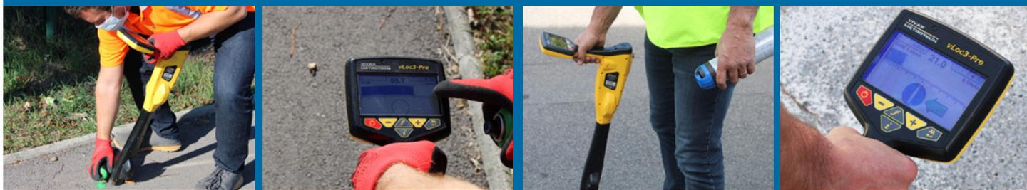
Pour répondre aux exigences de la réglementation anti-endommagement DT-DICT, et pour réaliser des investigations complémentaires fiables, les opérateurs doivent absolument maîtriser la méthode électromagnétique.
