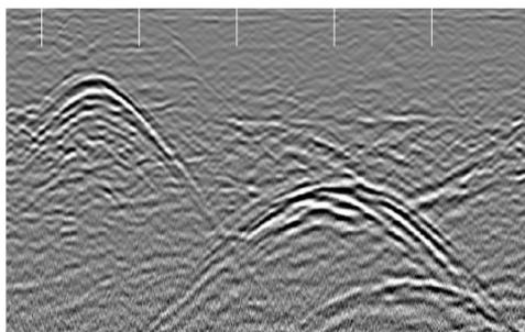
Trois canalisations en béton à différentes profondeurs
