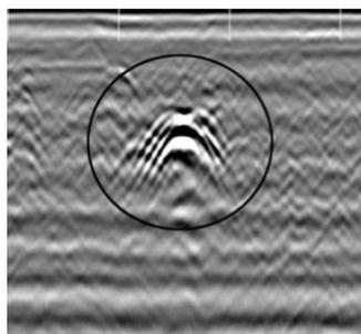
Plusieurs câbles électriques dans un même faisceau
