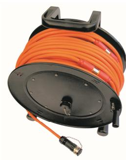
Câble 10 canaux multiélectrodes avec boîtier d'adressage et touret
