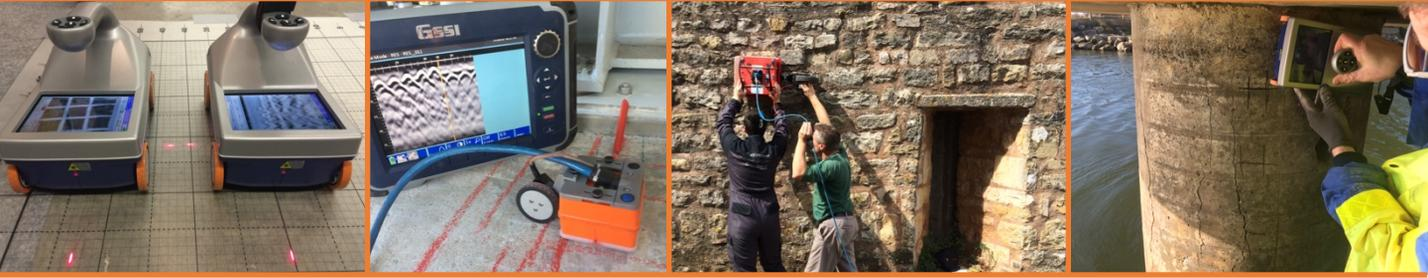
La méthode radar a de nombreuses applications dans le domaine des structures et ouvrages de génie civil. Une large gamme de matériels et antennes existe, permettant d'ausculter les structures plus ou moins profondément, et de moyenne à très haute résolution.
