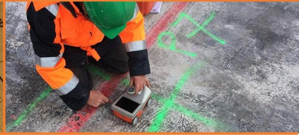
Lors de travaux de carottages ou perçages dans des structures de génie civil (voiles, dalles, poutres, massifs ...), il est souvent demandé de réaliser au préalable une **détection des armatures**, gaines de précontrainte, chauffage au sol, câbles électriques ou canalisations. Les plans existants sont souvent peu précis ou parfois même inexistants.
