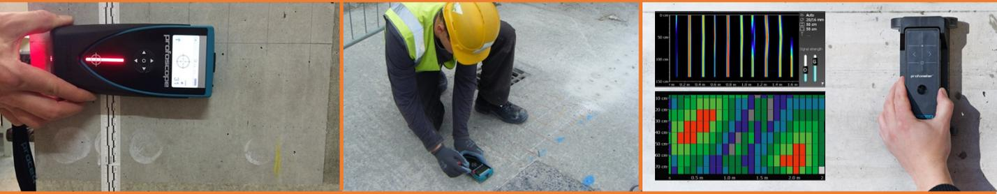
Avant travaux de carottages ou perçages dans des structures en béton armé, ou tout simplement pour contrôler l'enrobage, le nombre et les espacements des aciers présents, il est souvent demandé de réaliser une campagne de **détection des armatures**.
