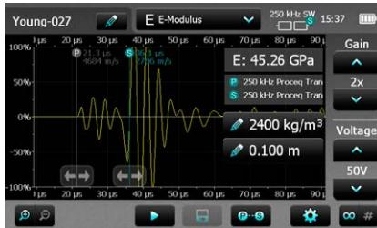
Le curseur double est automatiquement activé. Utilisez le premier curseur pour marquer le début du composant d'onde P. Utilisez le second curseur pour marquer le début du composant d'onde S. Afin de calculer le module d'élasticité E, il est nécessaire d'entrer la densité du matériau. Lorsqu'il est téléchargé sur PL-Link, le coefficient de Poisson du matériau est également calculé.
