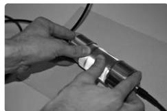
Couplez les transducteurs à la barre d'étalonnage (F) à l'aide du couplant ultrasonique (E) et appuyez fermement.
