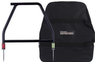
L'arceau est utilisé pour détecter des défauts à la terre sur des canalisations et des câbles. Dans le cas de canalisations, les défauts sont des défauts de revêtement. Dans le cas de câbles, les défauts sont en général dus à une isolation détériorée permettant le contact de la gaine métallique (ou conducteur interne) avec la terre.
