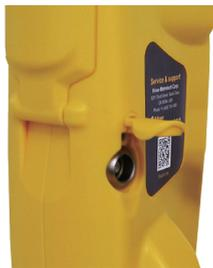
Connectez le chargeur à la prise de charge/accessoires du récepteur. Branchez le chargeur à l'alimentation secteur puis le mettre sous tension. Le témoin LED du chargeur s'allume en rouge pendant la charge des batteries, une fois ces batteries complètement chargées, il devient vert.
