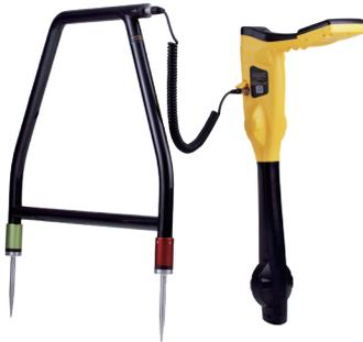
L'arceau analogique est utilisé pour détecter des défauts à la terre sur des canalisations et des câbles. Dans le cas de canalisations, les défauts sont des défauts de revêtement. Dans le cas de câbles, les défauts sont en général dus à une isolation détériorée permettant le contact de la gaine métallique (ou conducteur interne) avec la terre.
