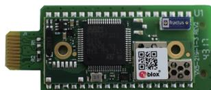
Le récepteur vLoc3-Pro peut être équipé en option d'un accessoire de communications Bluetooth qui permet la communication avec un GPS et/ou des enregistreurs de données externes. L'option Bluetooth peut être installée et commandée ultérieurement.
